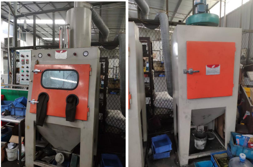
旋风分离+布袋收尘 图 4-3 废气处理设施图
